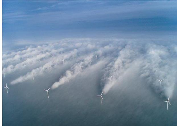
Abbildung 10: Wirbelschleppen an Windanlagen [Foto Steiness/Vattenfall]
